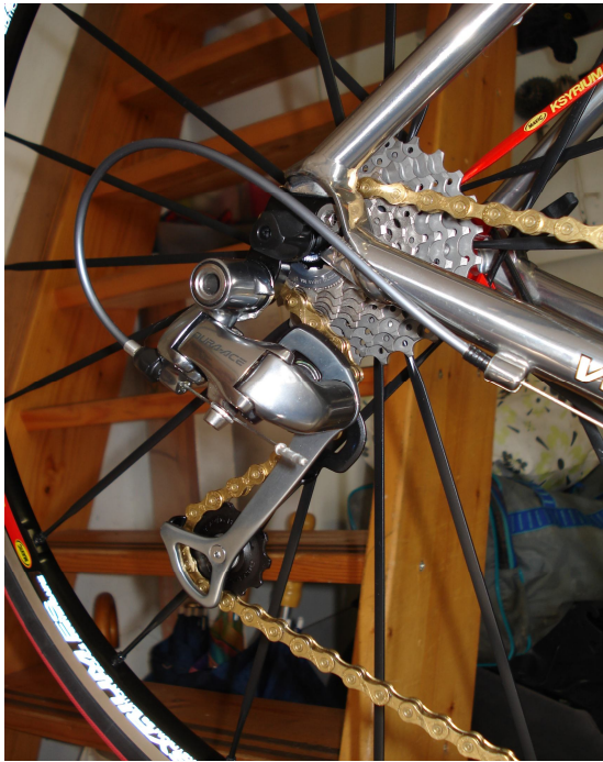
Afb.2: derailleur met 10-speed cassette
